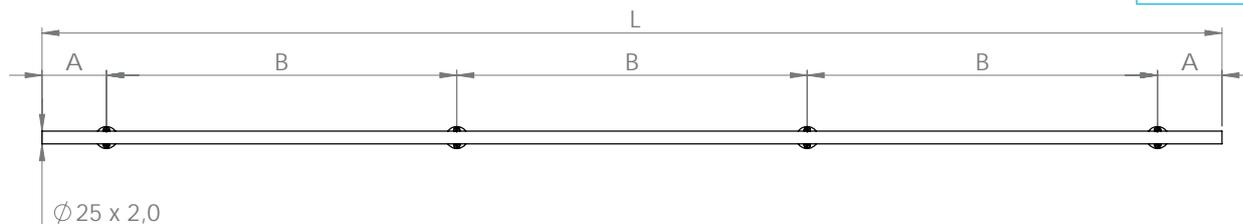
**Laufschiene für Glasschiebetür mit Gewinde M8**
