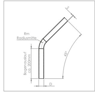
**Rohrbogen 45° mit Bogenauslauf ca. 200 mm**
