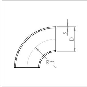
**Rohrbogen 90°, Bauart 3**
