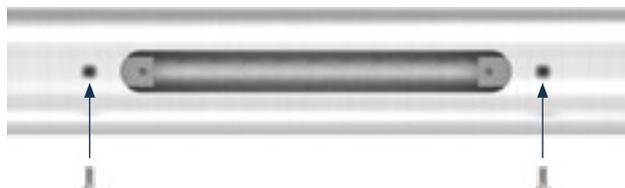
**Schritt 2:** Schrauben Sie die Nutsteine mit den beiliegenden Befestigungsschrauben M3x6 mm an das Bauteil.
