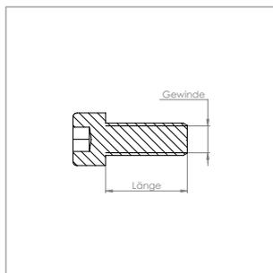
**Zylinderkopfschraube mit Innensechskant**
