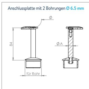
**Handlaufstütze mit Anschlussplatte 90°**
