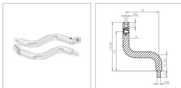
**Gelenkbügel mit 1x Außen- und 1x Innengewinde**
