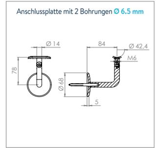
Anschlussplatte mit 2 Bohrungen Ø 6.5 mm
