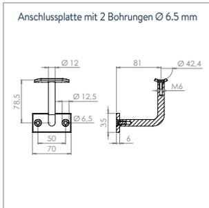
Anschlussplatte mit 2 Bohrungen Ø 6.5 mm
