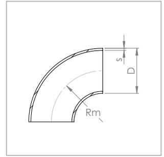
**Rohrbogen 90°, Bauart 3**
