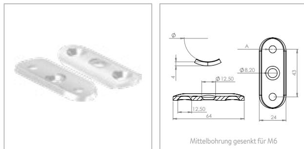
**Anschlussplatte 64 x 24 x 4 mm, gesenkt für M6**
