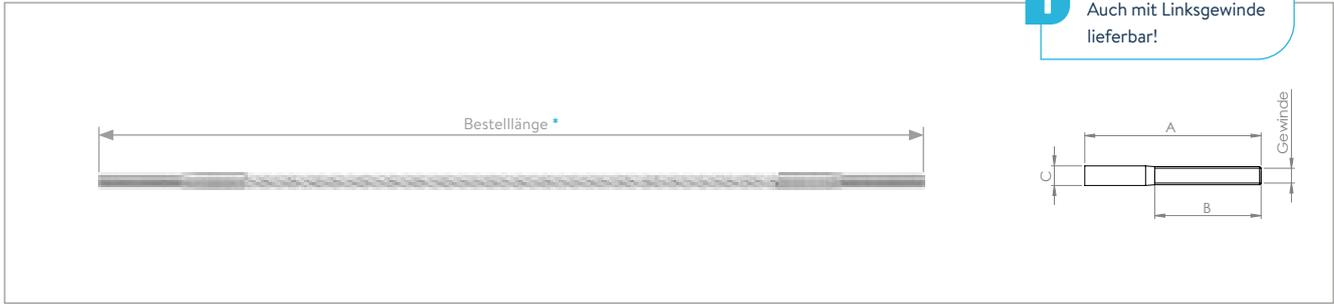
**Seil mit beidseitigem Außengewinde rechtsgängig verpresst**
