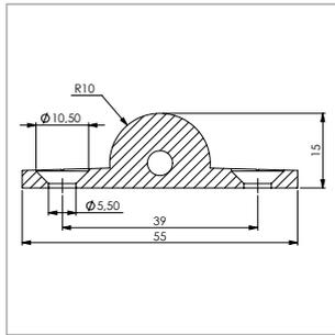
**Laufschiene zum Aufschrauben mit Senkbohrungen, Aluminium**
