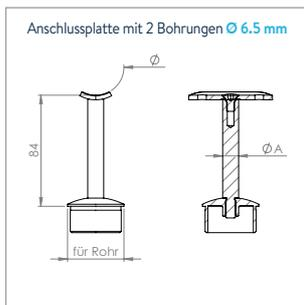
**Handlaufstütze mit Anschlussplatte**
