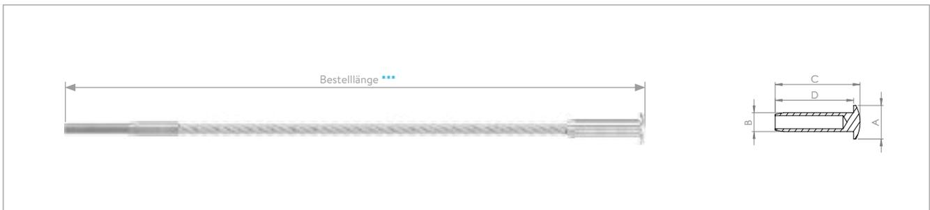
**Seil mit 1x Linsenkopfterminal und 1x Außengewinde rechtsgängig verpresst**
