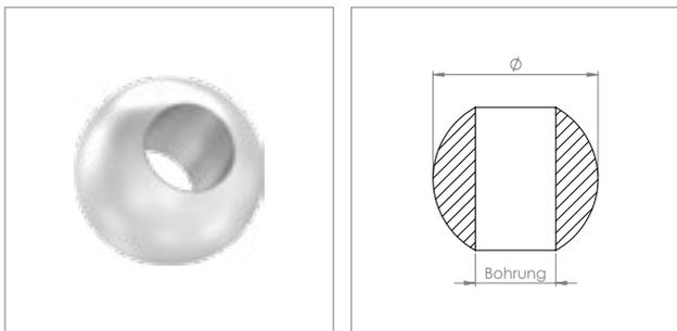
**Vollkugel mit Durchgangsbohrung**
