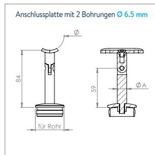
**Handlaufstütze mit Anschlussplatte und Gelenk**
