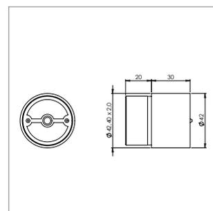
**Verbinder für Holzhandlauf Ø 42mm auf Rundrohr 42,4 x 2,0mm**
