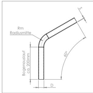
**Rohrbogen 60° mit Bogenauslauf ca. 200 mm**
