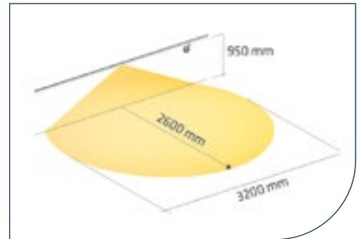
Alle Angaben sind Näherungswerte und abhängig von der Oberfläche, die angestrahlt wird, sowie der Reflektion der Befestigungswand. Die Werte wurden im Versuch mit Luxmeter senkrecht zur Lichtachse ermittelt.
