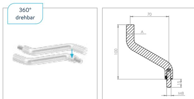
**Bügel mit 1x Außengewinde und 1x flach**
