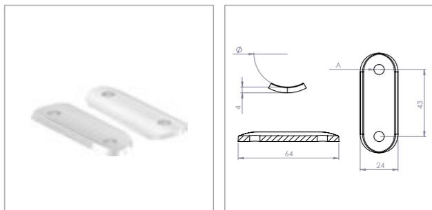
**Anschlussplatte 64x24x4 mm, ohne Mittelbohrung**
