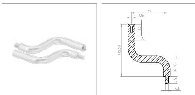
**Bügel mit 1x Außen- und 1x Innengewinde**
