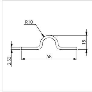
**Laufschiene zum Aufschrauben**
