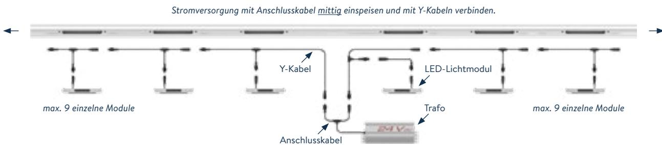
**BITTE BEACHTEN:** Die Stromversorgung mittels Netzteil /Trafo ist mittig einzuspeisen. Pro Seite können bis zu 9 Module in Reihe geschaltet werden. Das Anschlusskabel verbindet den Trafo mit den Y-Kabeln. Die Y-Kabel fungieren sowohl als Anschluss für die
