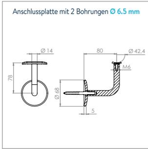
Anschlussplatte mit 2 Bohrungen Ø 6.5 mm
