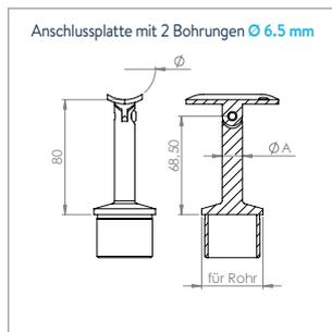
**Handlaufstütze mit Anschlussplatte und Gelenk**
