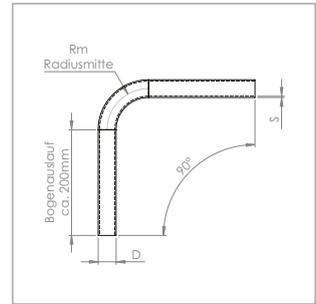
**Rohrbogen 90° mit Bogenauslauf ca. 200 mm**
