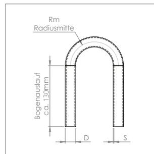
**Rohrbogen 180° mit Bogenauslauf ca. 130 mm**
