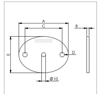
**Ankerplatte oval, ohne Fase, mit Längsschliff**
