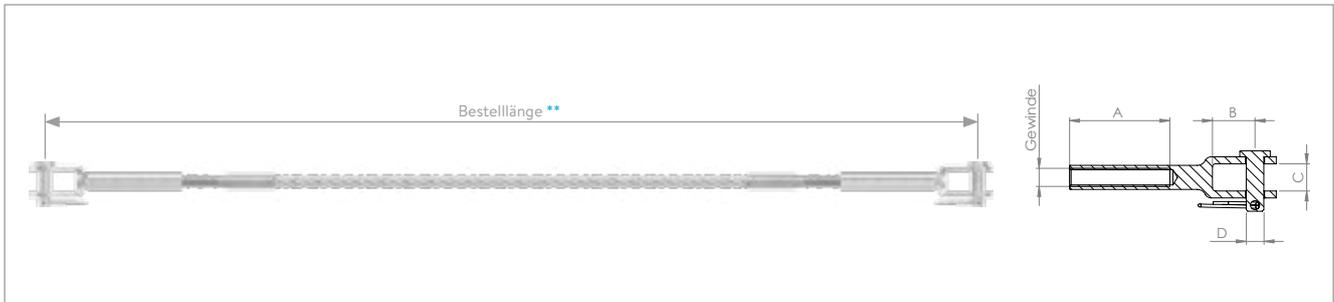
**Seil mit 1x Links- und 1x Rechtsgewinde verpresst (Gabelterminal halb aufgedreht)**
