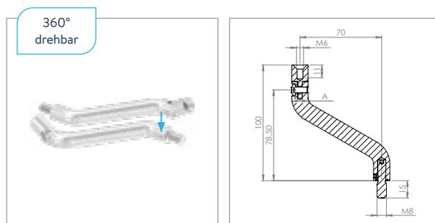
**Gelenkbügel mit 1x Außen- und 1x Innengewinde**
