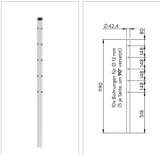
**Eckpfosten 90°, 5x Bohrung zweiseitig für Ø 12 mm**
