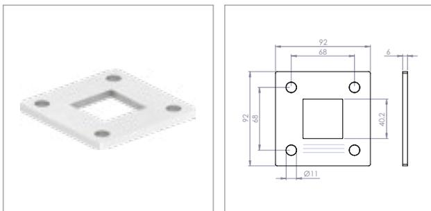
**Ankerplatte quadratisch, mit Längsschliff**
