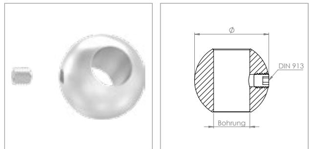
**Vollkugel mit Durchgangsbohrung zum Klemmen**
