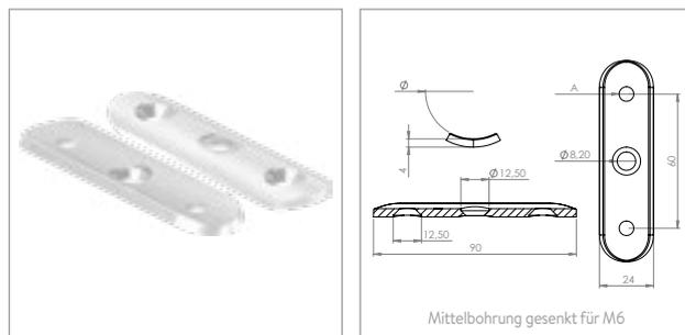
**Anschlussplatte 90 x 24 x 4 mm, gesenkt für M6**
