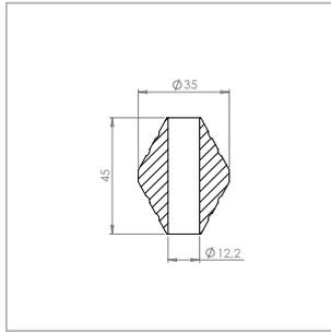
**Zierhülse mit Durchgangsbohrung**
