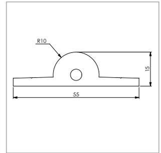
**Laufschiene zum Aufschrauben ohne Senkbohrungen, Aluminium**
