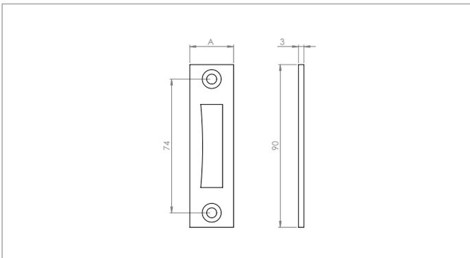
**Schließblech, für Rohrrahmen-Riegelschlösser**
