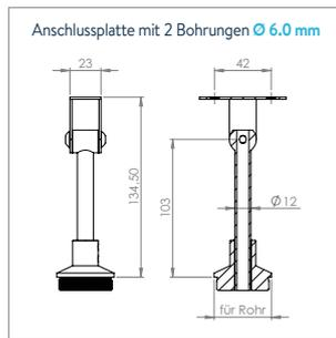
**Handlaufstütze hohl für LED-Nutrohr**
