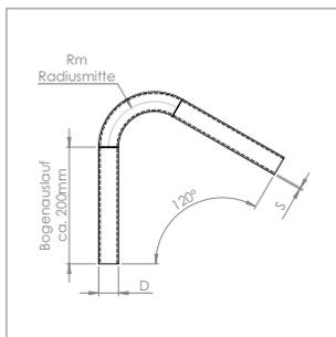
**Rohrbogen 120° mit Bogenauslauf ca. 200 mm**
