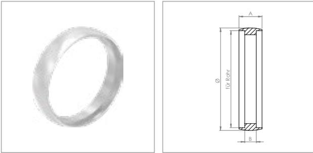
**Verbindungsring, zum Verdecken der Schnittkanten**
