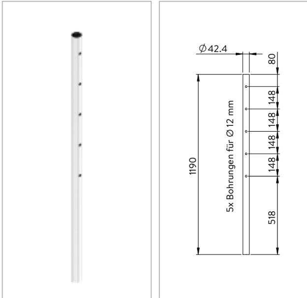
**Pfosten, 5x Bohrung einseitig für Ø 12 mm**
