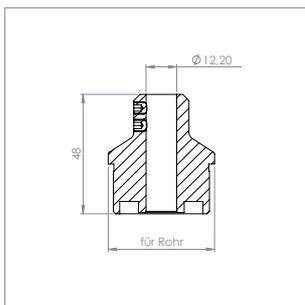
**Stopfen mit Durchgangsbohrung, zum Klemmen**
