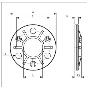
**Ankerplatte rund, mit Gummiring, ungeschliffen**
