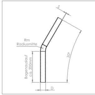
**Rohrbogen 30° mit Bogenauslauf ca. 200 mm**
