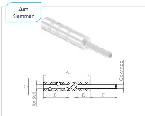
**Gewindeterminale mit Außengewinde (rechtsgängig)**
