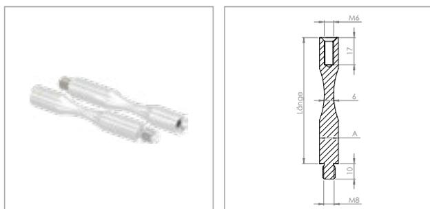
**Stift zum Biegen mit 1x Außen- und 1x Innengewinde**
