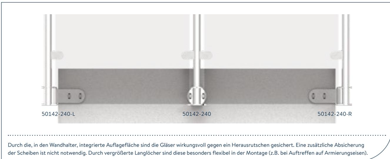
Durch die, in den Wandhalter, integrierte Auflagefläche sind die Gläser wirkungsvoll gegen ein Herausrutschen gesichert. Eine zusätzliche Absicherung der Scheiben ist nicht notwendig. Durch vergrößerte Langlöcher sind diese besonders flexibel in der Montage (z.B. bei Auftreffen auf Armierungseisen).
