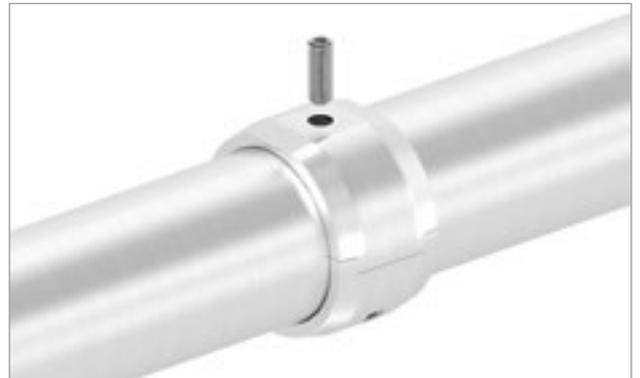
**4. SCHRITT:** Gewindestift oben eindrehen. Empfehlung: Gewinde in das bestehende Handlaufrohr einschneiden und Schraube etwas eindrehen.
