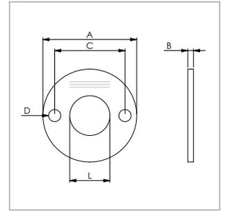
**Ankerplatte rund, ohne Fase, mit Längsschliff**
