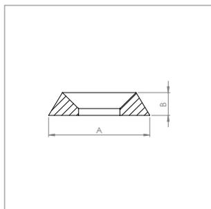
**Schraubenrosette für Senkkopfschraube**
