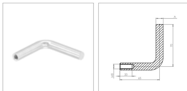
**Bügel, passend für Drehfix®-Ankerstange**
