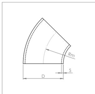
**Rohrbogen 45°, Bauart 3**
