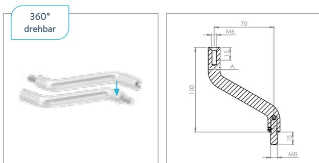
**Bügel mit 1x Außen- und 1x Innengewinde**
