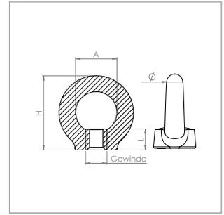
**Ringschraube mit Außengewinde**
