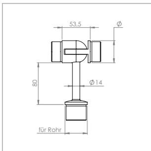
**Handlaufstütze mit verstellbarem Gelenkstück**
