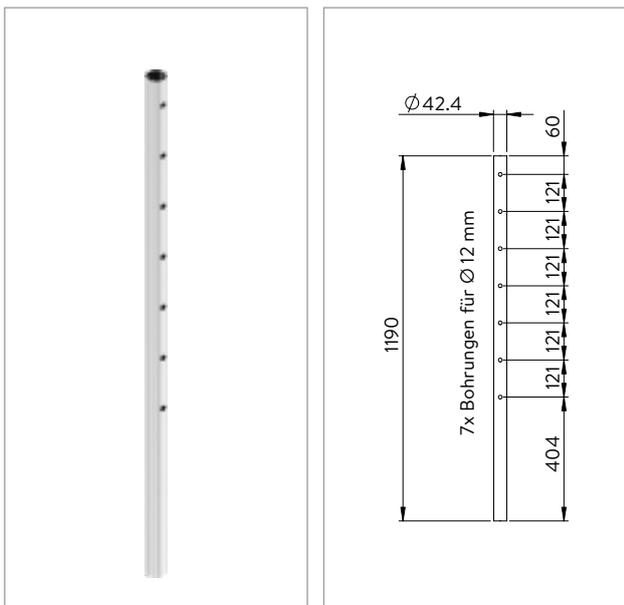
**Pfosten, 7x Bohrung einseitig für Ø 12 mm**
