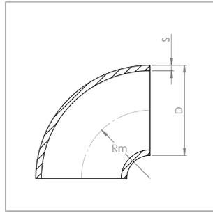
**Rohrbogen 90°, Bauart 2**
