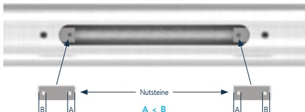
**Schritt 1:** Arbeiten Sie den notwendigen Ausschnitt nach Zeichnung in Ihr Bauteil ein. Entgraten Sie die Innenseite des Ausschnitts und der Bohrungen. Schieben Sie den Nutstein nach Zeichnung (geringstes Maß [A] in Ausbruch zeigend) mit Hilfe einer abgewinkelten Zange in das Bauteil.
