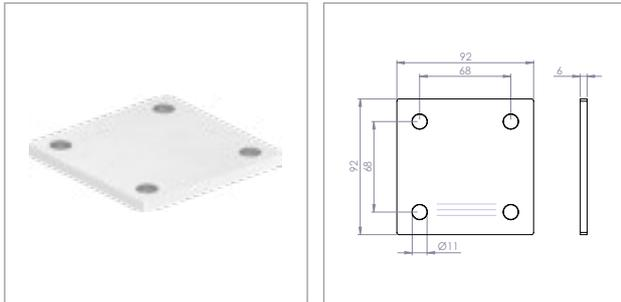
**Ankerplatte quadratisch, mit Längsschliff**
