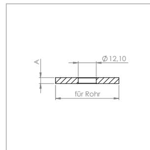
**Rohrabschlussplatte flach, mit Bohrung**
