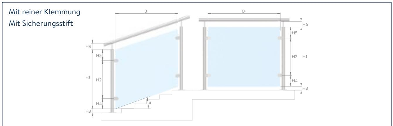
Achtung pro Glasfeld nur einen Sicherungsstift einsetzen (bei mehr als einer Bohrung erlischt die AbZ).
