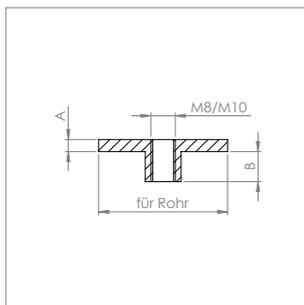
**Rohrabschlussplatte flach, mit Innengewinde**
