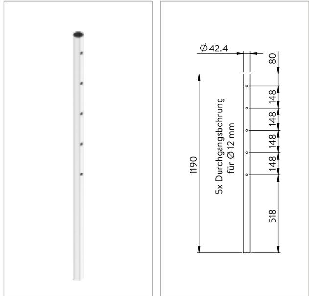
**Mittelpfosten 180°, 5x Durchgangsbohrung für Ø 12 mm**
