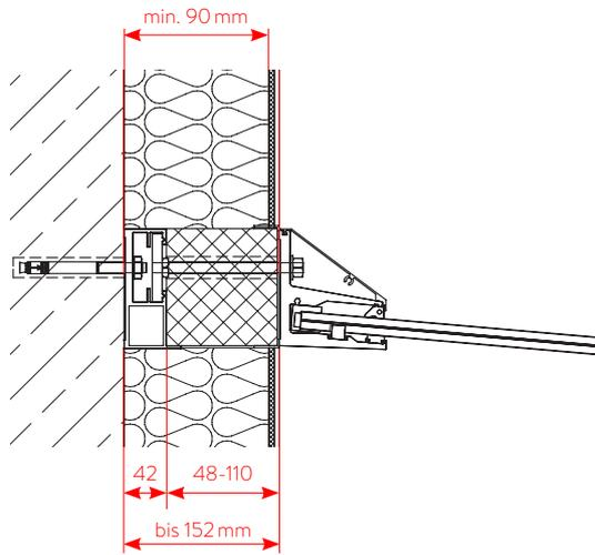
Mit Dämmkörper 160mm:
