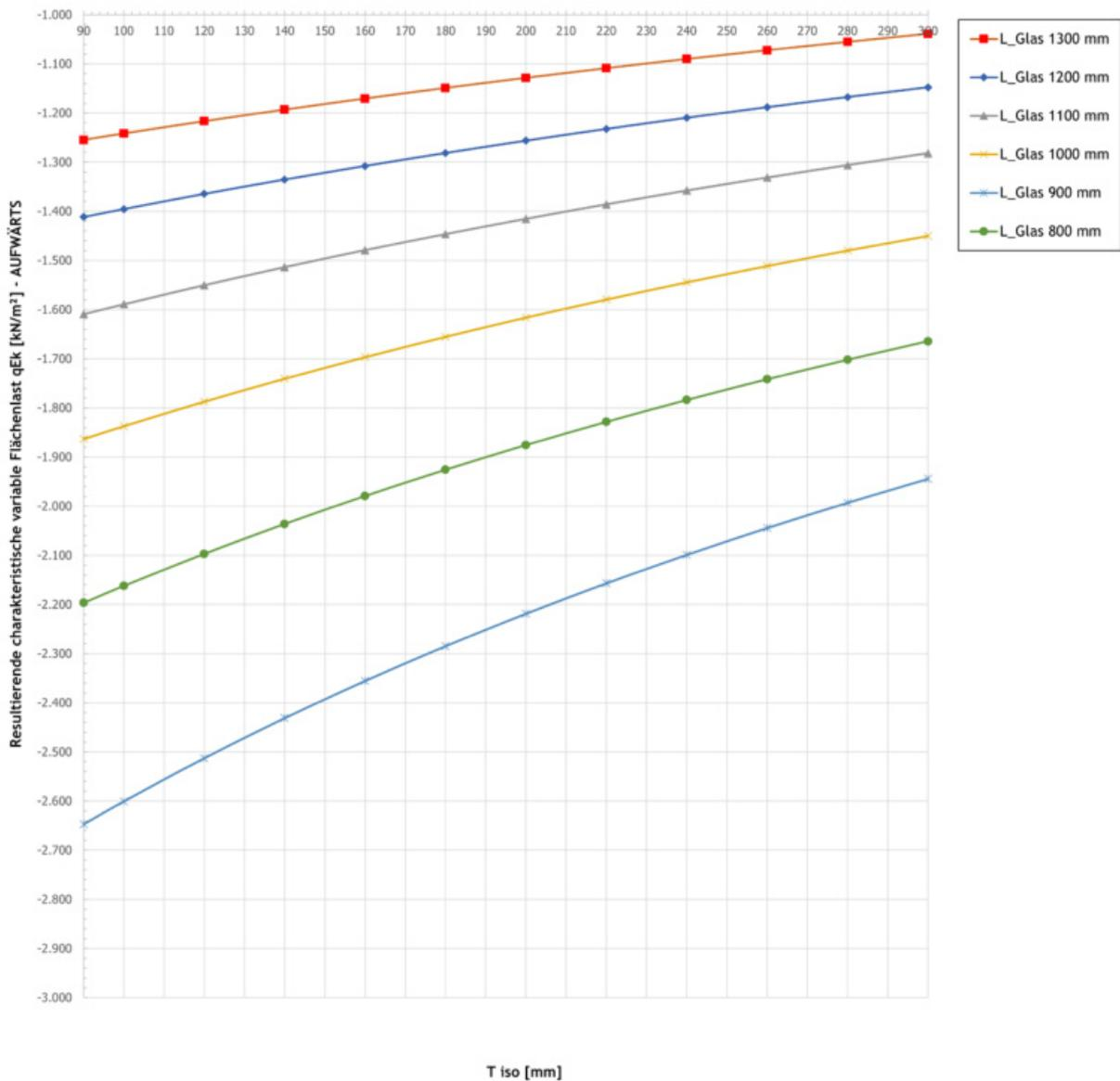
Maximale charakteristische Flächenlasten in Abhängigkeit von Dämmstärke (T<sub>iso</sub>) und Auskragung (A):
