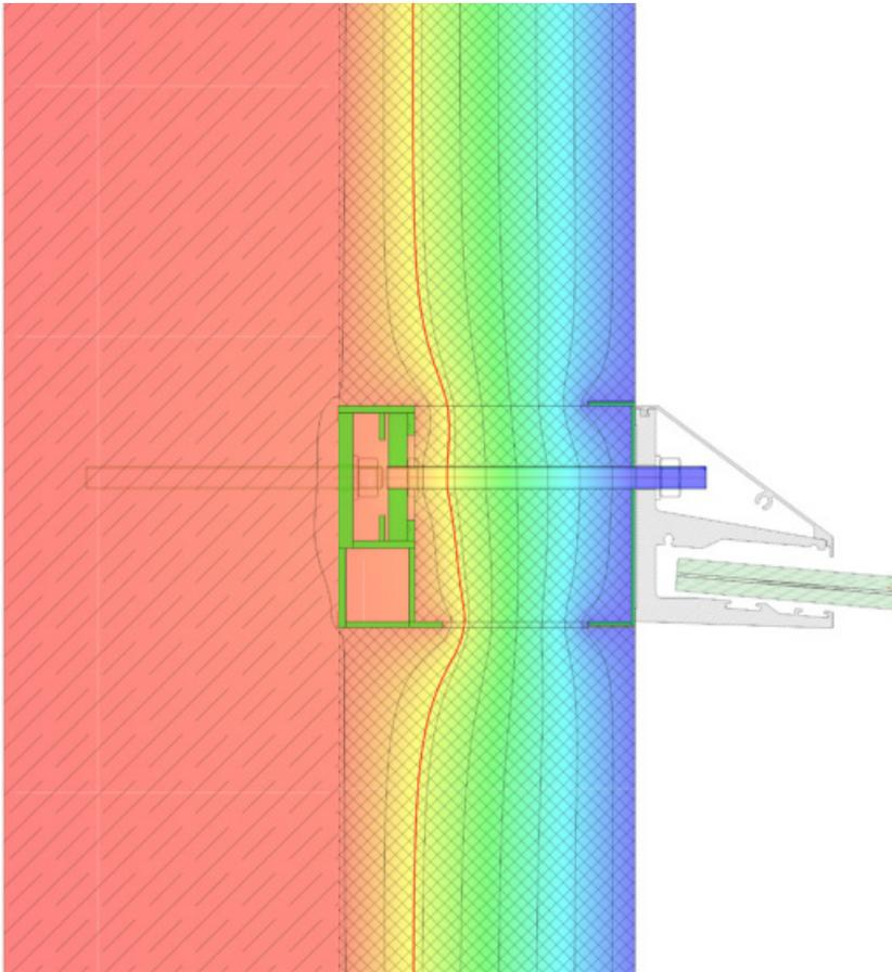
Abb.: Darstellung des Temperaturverlaufs in einem 2D Schnitt als Falschfarbenbild, rot 12,7°C
