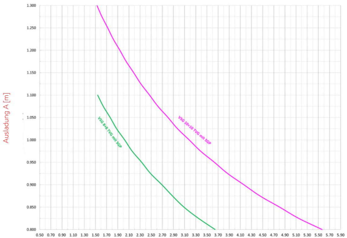
Resultierende charakteristische variable Flächenlast  $q_{Ek}$  [kN/m<sup>2</sup>] - ABWÄRTS
