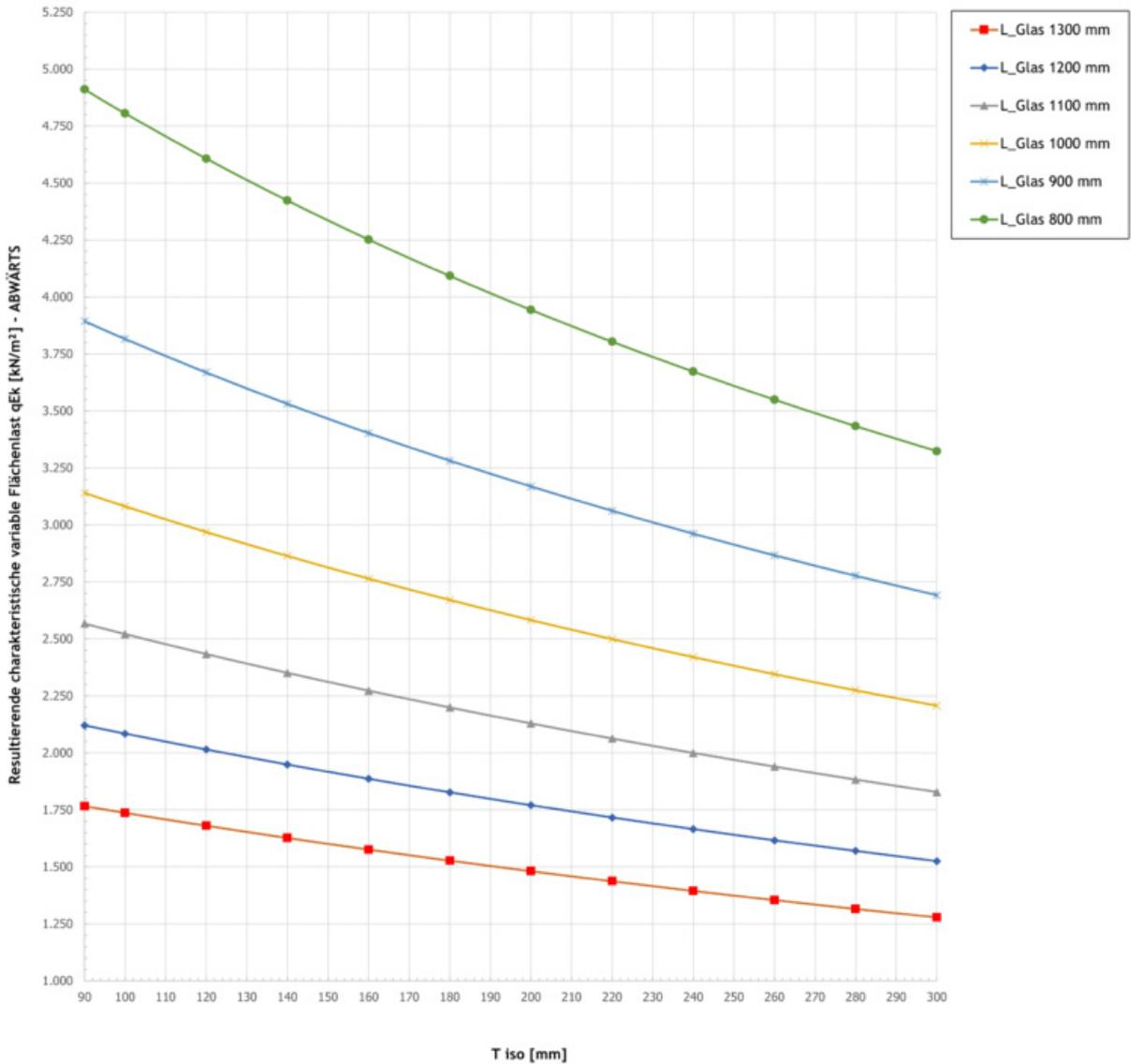
Maximale charakteristische Flächenlasten in Abhängigkeit von Dämmstärke (T<sub>iso</sub>) und Auskrägung (A):
