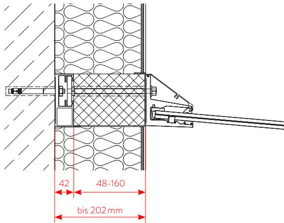
Mit Dämmkörper 260mm:
