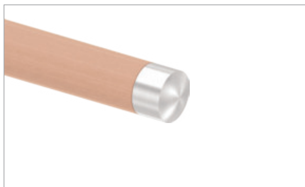
6. SCHRITT: Endcappe aufsetzen und Metallkleber aushärten lassen.
