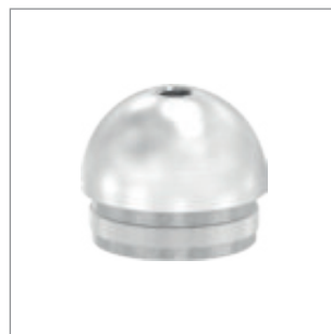
Rohrabschlussstopfen halbrund, mit Innengewinde hohl/gegossen, zum Einschlagen, mit Rändelung, geschliffen K240
