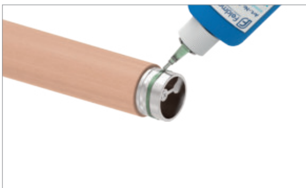
5. SCHRITT: Auftragen eines Metallklebers (z.B. 7080-K) auf den Adapter.
