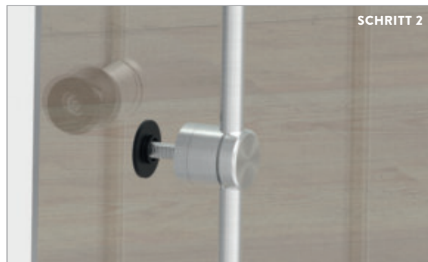
2. SCHRITT: Lockeres Aufdrehen der Gewinde auf den Grundhalter und aufschieben der Gummis.
