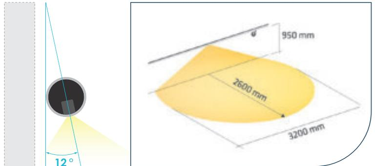
Alle Angaben sind Näherungswerte und abhängig von der Oberfläche, die angestrahlt wird, sowie der Reflektion der Befestigungswand. Die Werte wurden im Versuch mit Luxmeter senkrecht zur Lichtachse ermittelt.
