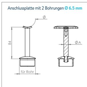
**Handlaufstütze mit Anschlussplatte**
