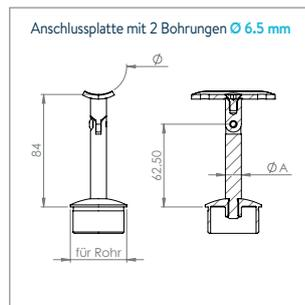
**Handlaufstütze mit Anschlussplatte und Gelenk**
