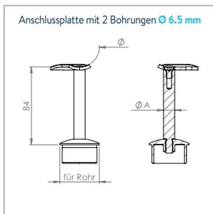
**Handlaufstütze mit Anschlussplatte 90°**
