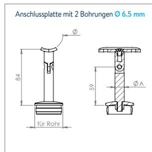
**Handlaufstütze mit Anschlussplatte und Gelenk**
