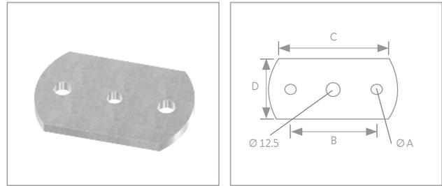
**Ankerplatte mit 2x Rundloch und Mittelbohrung |**
