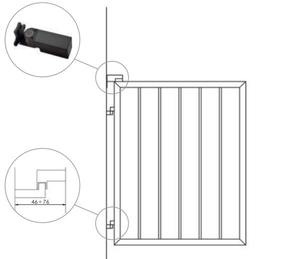
Einbausituation 2 zeigt die Montage des Torschließers von oben. Hierbei müssen Schließer und Torbänder auf einer Achse liegen. Der Schließer dient zum automatischen Schließen von Toren.
