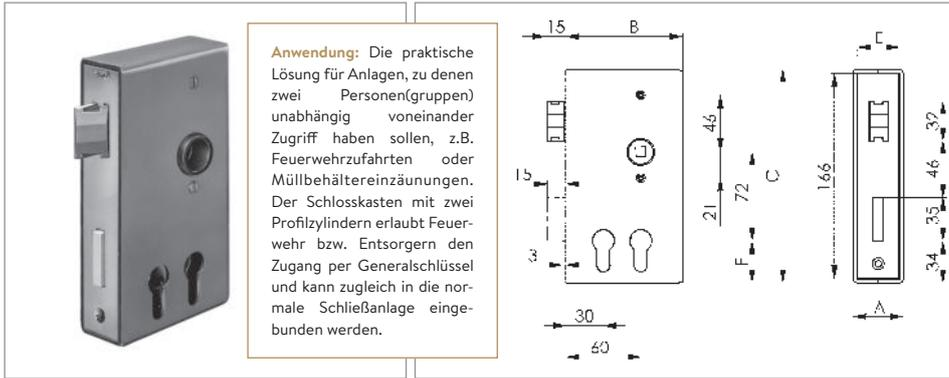
**Anwendung:** Die praktische Lösung für Anlagen, zu denen zwei Personen(gruppen) unabhängig voneinander Zugriff haben sollen, z.B. Feuerwehzufahrten oder Müllbehältereinzäunungen. Der Schlosskasten mit zwei Profilzylindern erlaubt Feuerwehr bzw. Entsorgern den Zugang per Generalschlüssel und kann zugleich in die normale Schließanlage eingebunden werden.
