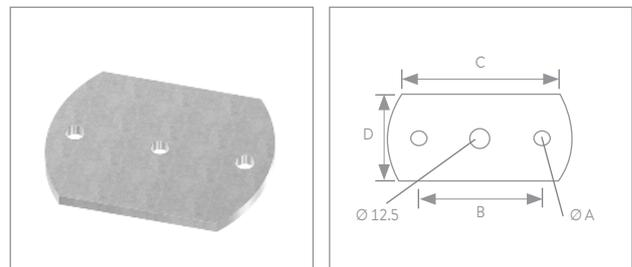
**Ankerplatte mit 2x Rundloch und Mittelbohrung |**
