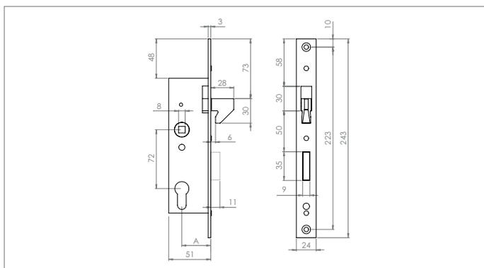
**Rohrrahmenschluss verzinkt mit Hakenfalle (z.B. für Schiebetore)**
