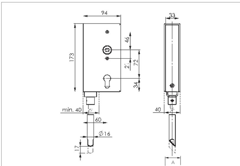
**Schlosskasten mit Schloss für Verriegelung nach unten** |
