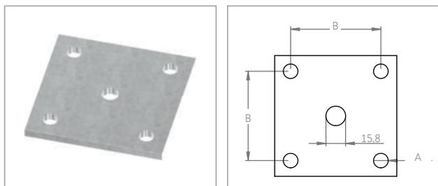
**Ankerplatte mit 4 Bohrungen und Mittelbohrung** |
