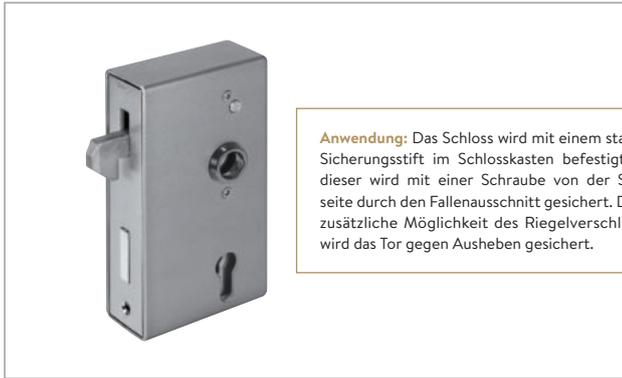
**Anwendung:** Das Schloss wird mit einem stabilen Sicherungsstift im Schlosskasten befestigt und dieser wird mit einer Schraube von der Stulpseite durch den Fallenausschnitt gesichert. Durch zusätzliche Möglichkeit des Riegelverschlusses wird das Tor gegen Ausheben gesichert.
