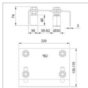
**Führungsbügel verstellbar, zum Anschweißen |**
