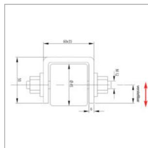
**Führungsrolle mit Bügel, zum Anschrauben |**
