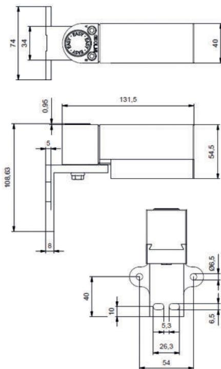
Tragfähigkeit: **max. 80 kg** bei Torbreite: **max. 1000 mm**
