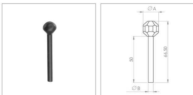
**Kugelpkopfbolzen, mit Kugel, abgehämmert |**
