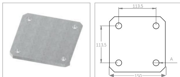
**Ankerplatte mit 4 Bohrungen** |
