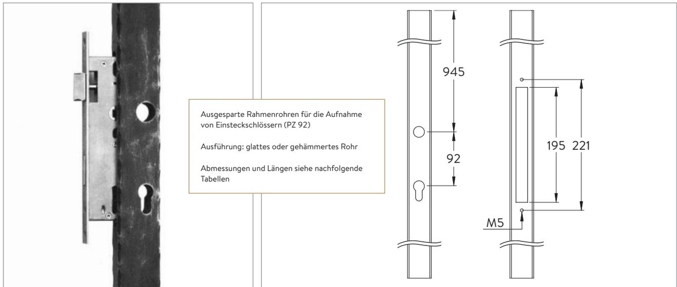
Ausgesparte Rahmenrohren für die Aufnahme von Einsteckschlössern (PZ 92)
