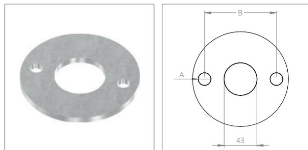
**Ankerplatte mit 2 Bohrungen und Mittelbohrung |**
