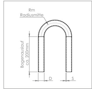
**Rohrbogen 180° mit Bogenauslauf ca. 200 mm |**
