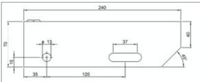
**Gitterroststufen 600-4200 mm**
