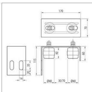
**Führungsbügel verstellbar, zum Anschrauben |**
