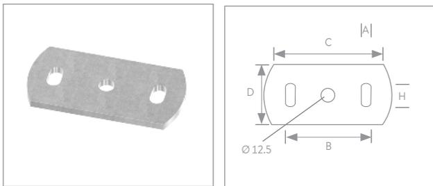
**Ankerplatte mit 2x Langloch und Mittelbohrung |**
