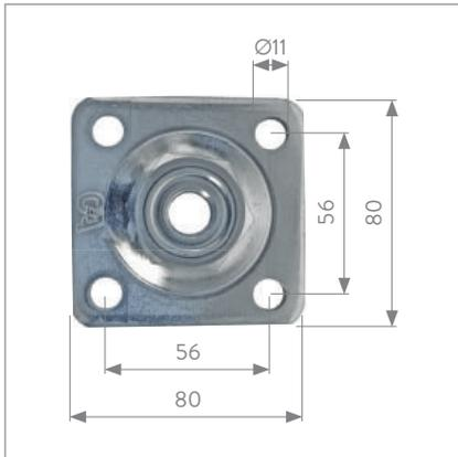
**Verstellbare Mauerplatte, 80 x 80 mm |**
