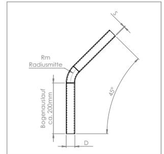
**Rohrbogen 45° mit Bogenauslauf ca. 200 mm**
