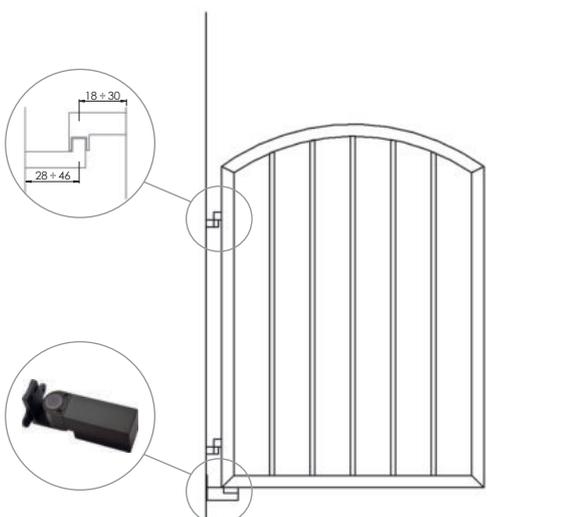
Einbausituation 1 zeigt die Montage des Torschließers von unten. Hierbei müssen Schließer und Torbänder auf einer Achse liegen. Der Schließer dient zum automatischen Schließen von Toren.
