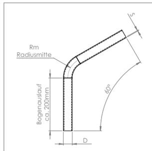
**Rohrbogen 60° mit Bogenauslauf ca. 200 mm**
