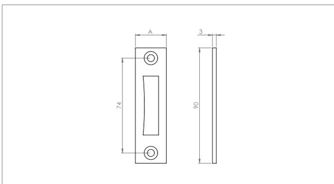
**Schließblech, für Rohrrahmen-Riegelschlösser**
