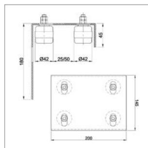
**Führungsbügel verstellbar, zum Anschrauben |**
