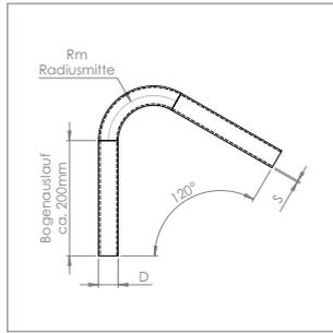
**Rohrbogen 120° mit Bogenauslauf ca. 200 mm |**
