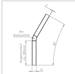
**Rohrbogen 30° mit Bogenauslauf ca. 200 mm**
