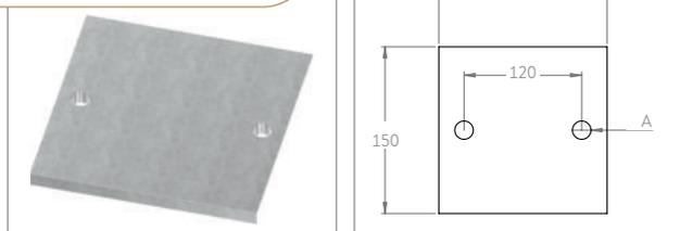
**Ankerplatte mit 2 Bohrungen** |
