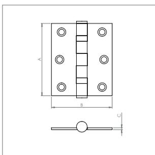
**Scharnier geschliffen mit festem Stift und 2x Kugellager**
