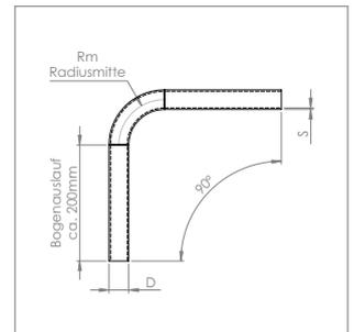
**Rohrbogen 90° mit Bogenauslauf ca. 200 mm**
