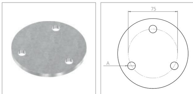
**Ankerplatte mit 3 Bohrungen |**
