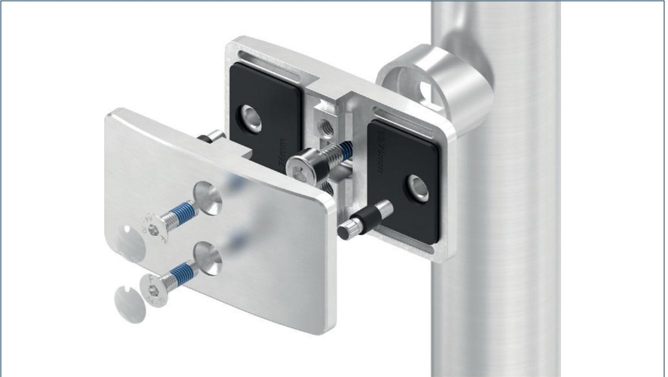
Die neuen Feldmann Sichtschutzklemmen werden nicht zwischen, sondern direkt vor den Geländerpfosten montiert. So können die Glasscheiben extrem nah aneinander positioniert werden. Der verbleibende kleine Spalt, wird durch den Edelstahlpfosten selbst verdeckt. Die perfekte Sichtschutzlösung!
